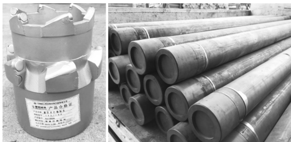
图4 \Phi 153\text{mm} 套铣钻头及 \Phi 127\text{mm} 套铣钻杆
