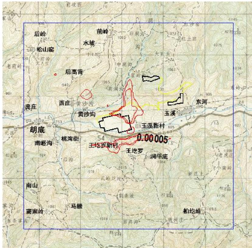
图 4-4-2  $\text{PM}_{10}$  年均落地浓度分布图 ( $\text{mg}/\text{m}^3$ )
