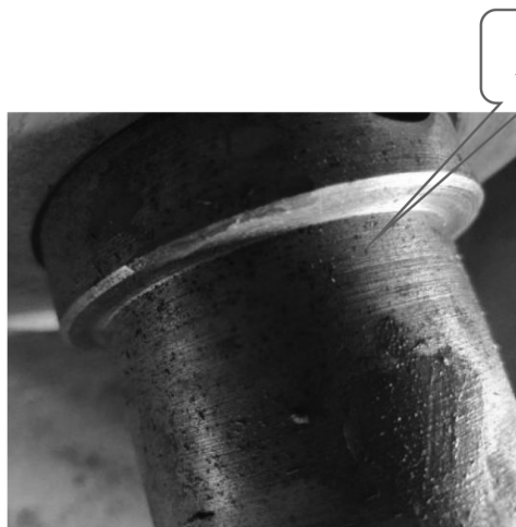
图 3 滚筒轴侧面加工刀痕
