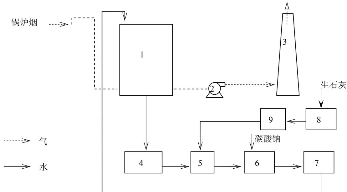
图 12-1 锅炉烟气除尘脱硫示意图
