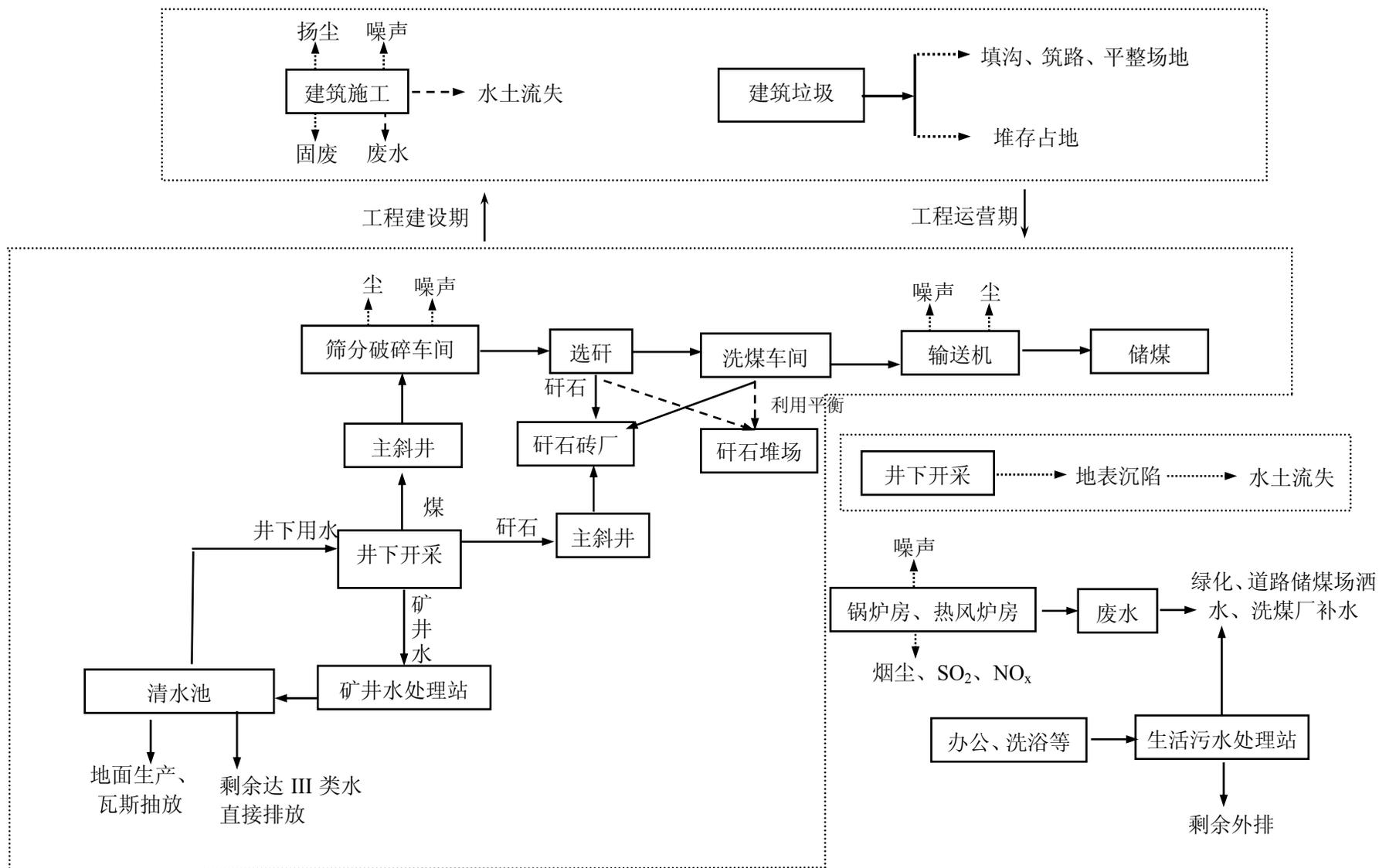
图 3-14 工程污染源及排污环节示意图
