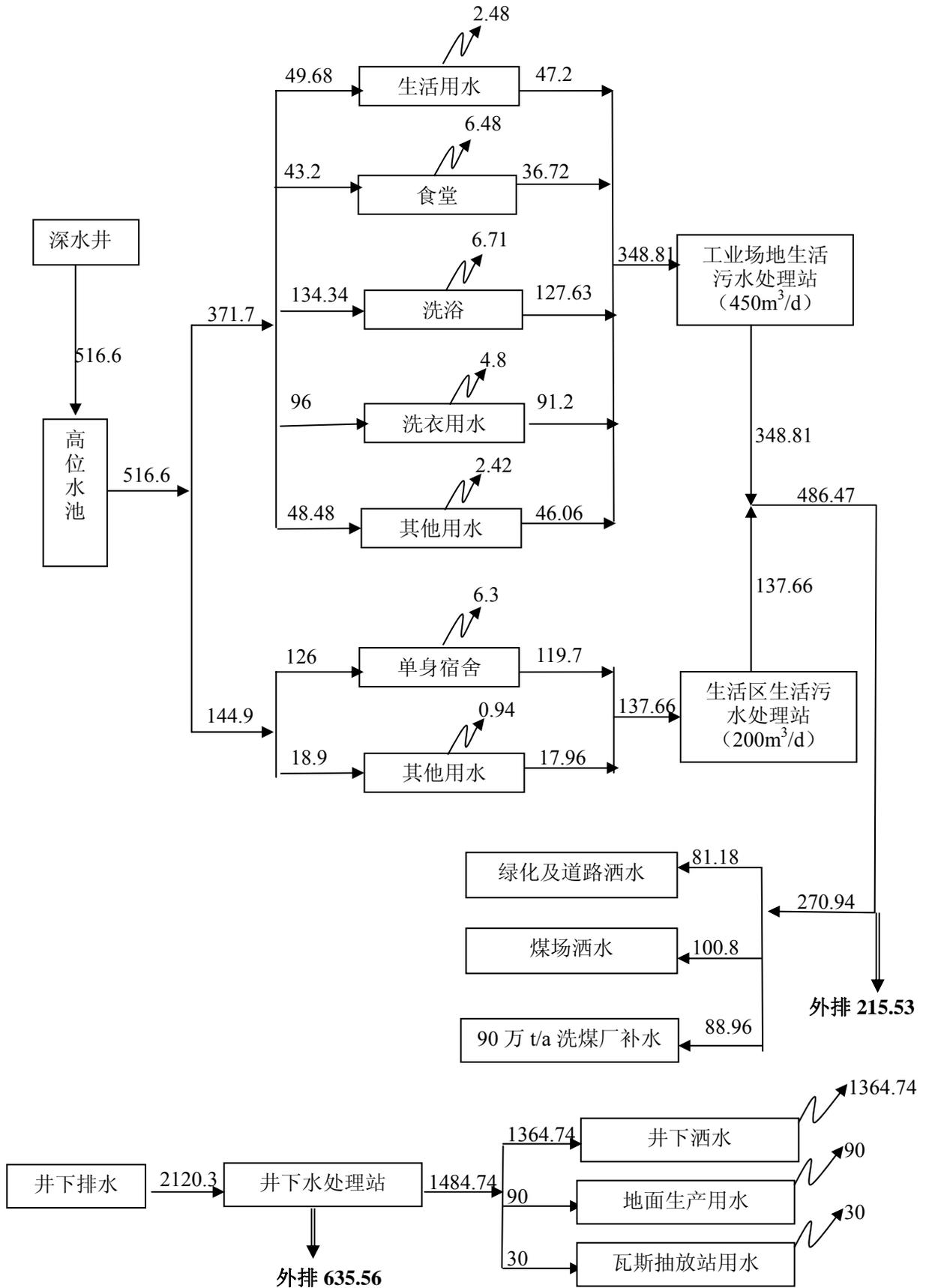
图 3-12 非采暖期水平衡图 (m³/d)
