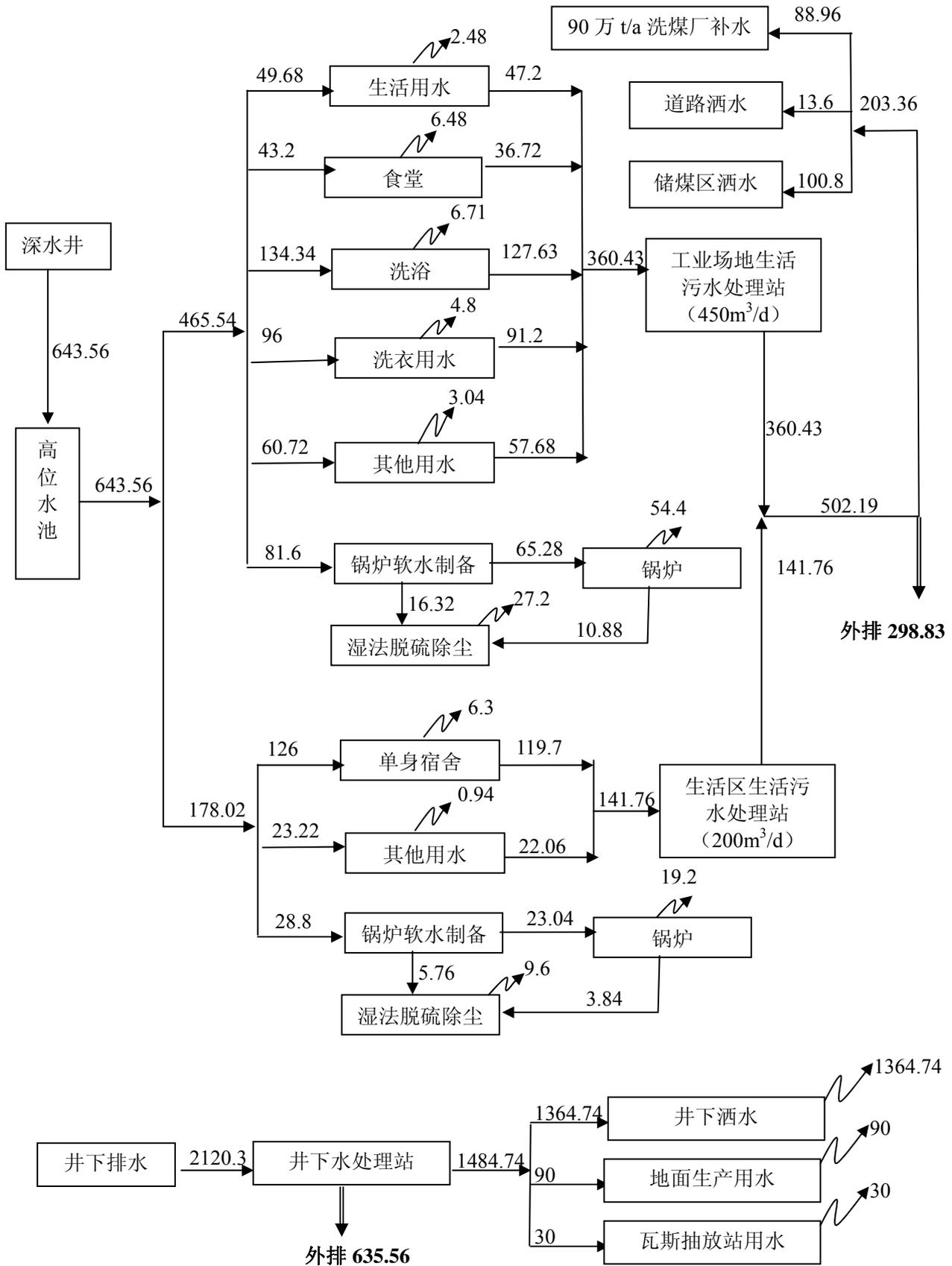
图 3-13 采暖期水平衡图 (m³/d)
